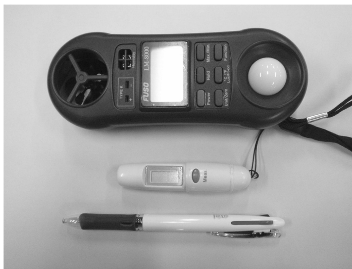
写真1 測定機器 (赤外線温度計TN006(下)とデジタルマルチ環境計測器LM-8000(上))
